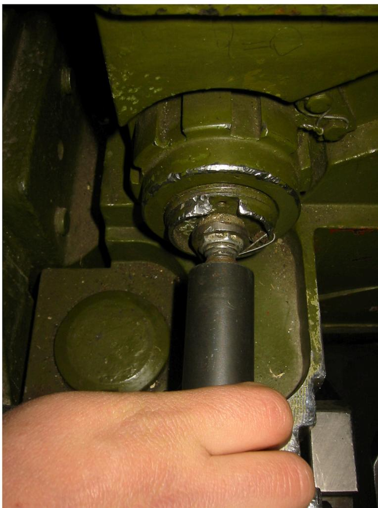
*Рис.6. Прибор для заправки жидкости.*
