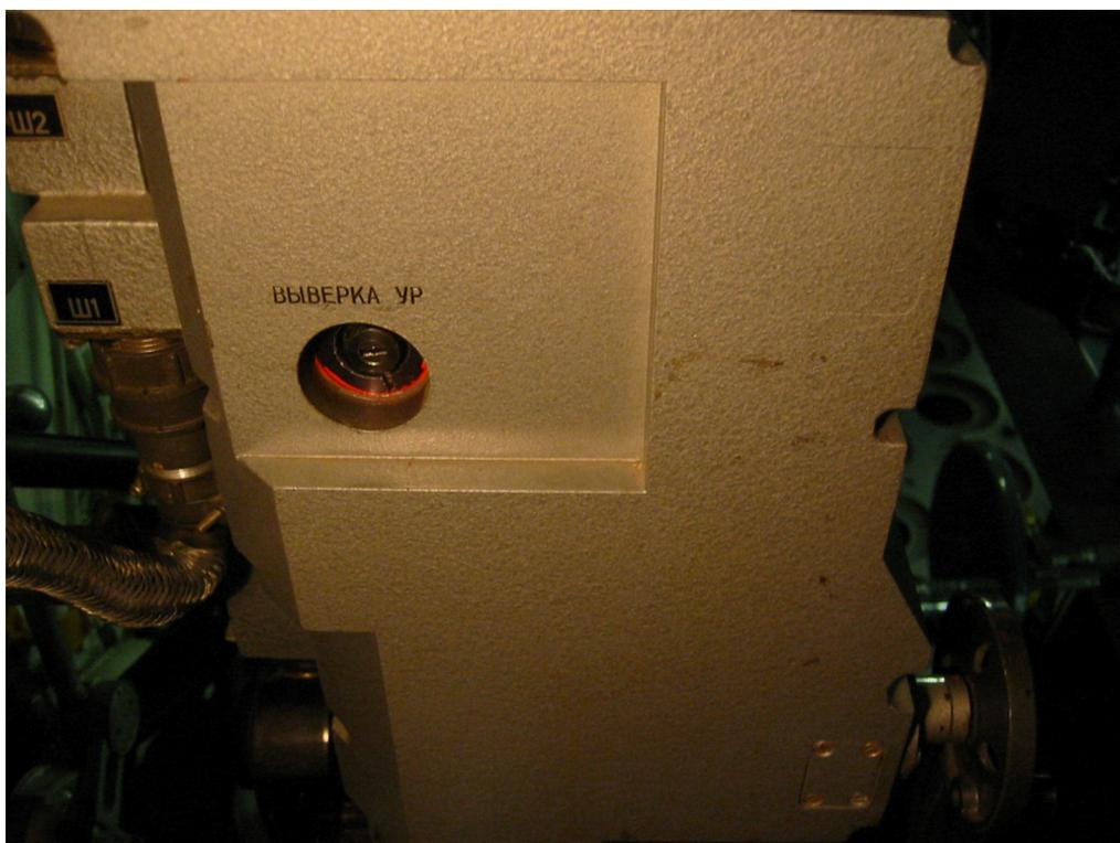
*Рис.4. Выверка датчика.*
