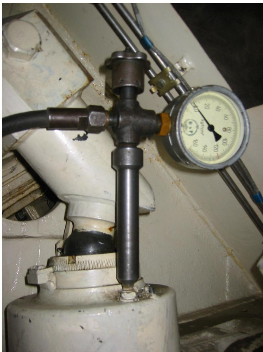
*Рис. 4.4.2. Тройник с манометром*
