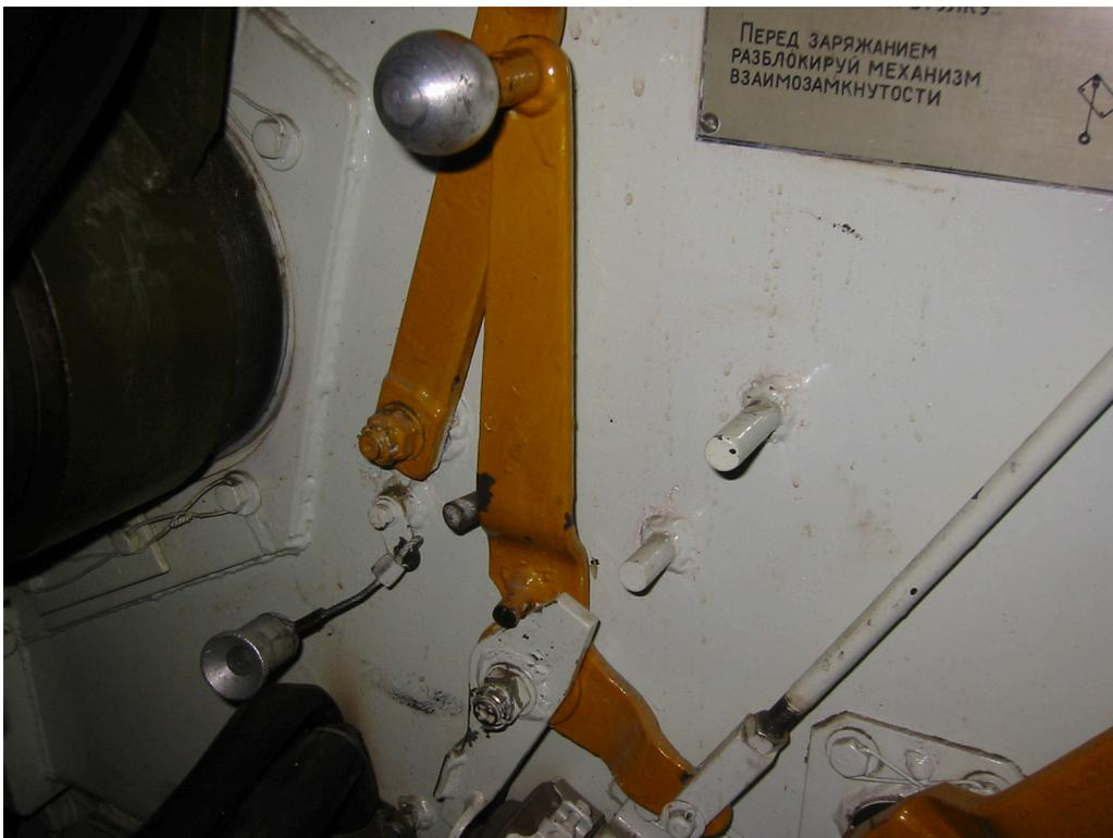
*Рис.6. Рычаг спуска*
