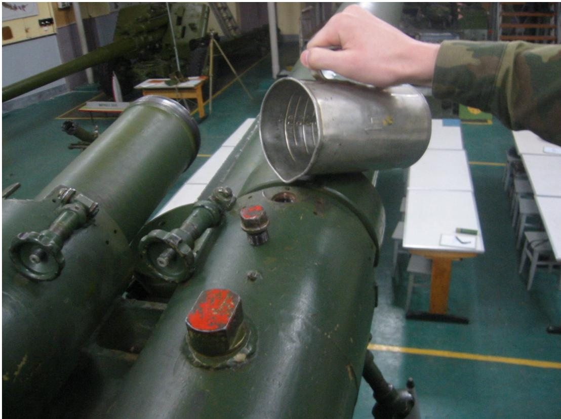
*Рис.3. Дозаправка жидкости в тормоз отката.*
