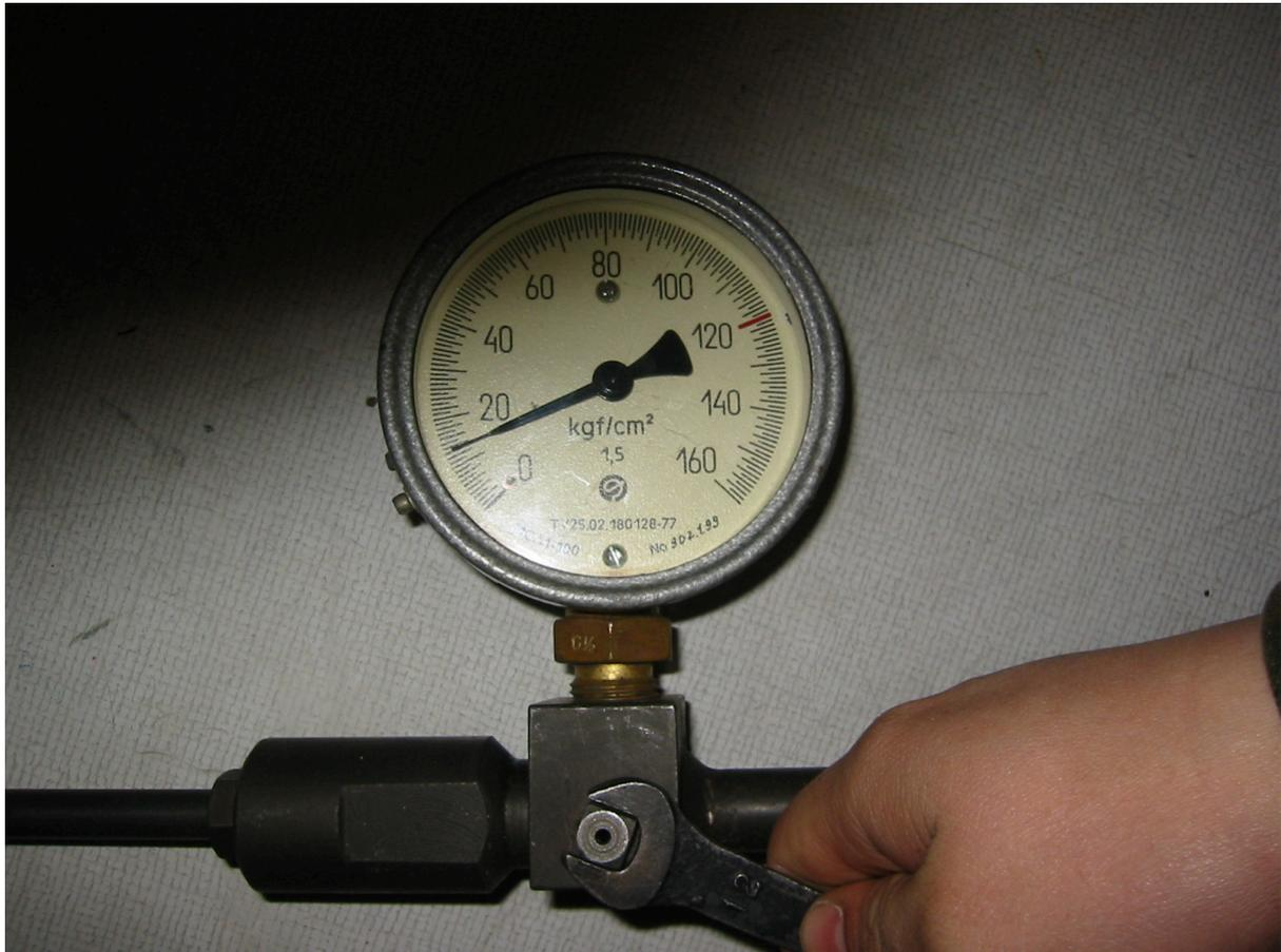
*Рис.11. Тройник с манометром.*
