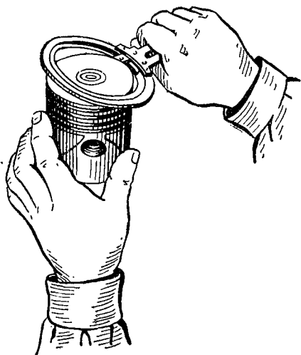
Рис. 54. Снятие поршневых колец специальным приспособлением для снятия и установки колец
