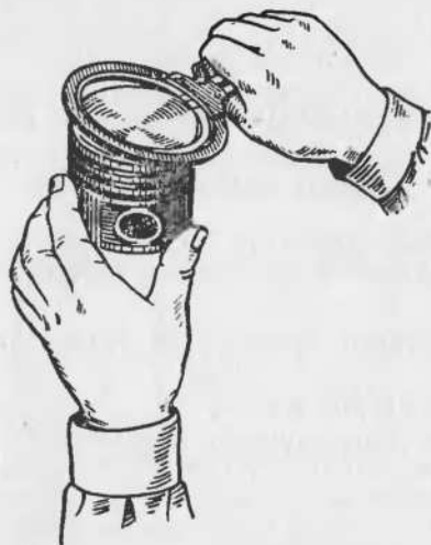
Рис. 60. Снятие поршневых колец специальным приспособлением
