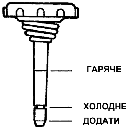
Рис. 1. Кришка бачка рідини гідропідсилювача (порядкові номери від 196900 і нижче).
