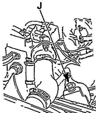
ЗАПОВНЕННЯ ТА РІВЕНЬ БАКА ГІДРОПІДСИЛЮВАЧА КЕРМОВОГО КЕРУВАННЯ (СЕРІЙНИЙ НОМЕР 196900 ТА НИЖЧЕ)
