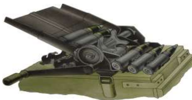
Рис. 16. Машинка для снаряжения и раснаряжения патронных лент 6Ю16 (набивочная машинка)
